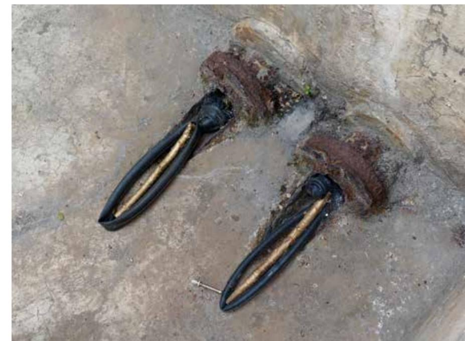
„Goldschläuche“ in Verbindung mit erodierten Eisenteilen.
